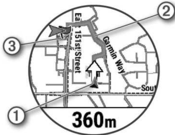
Auf der Karten werden die aktuelle Position (1), der zu verfolgende Track (2) sowie das Ziel (3) angezeigt.
